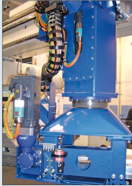
5: Das an der Hauptdrehachse des Feeder-Plus eingesetzte Planetengetriebe TP* 500 ist von außen nahezu unsichtbar. Es ermöglicht hochdynamische Rotationsbewegungen.
