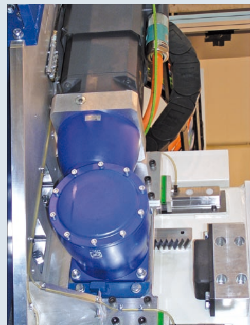
3: Eines der beiden Servowinkelgetriebe kommt an der Horizontalachse des Linearroboters zum Einsatz.
