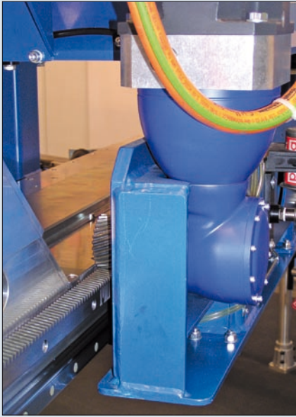
4: Auch an der Linearhubachse des Schwenkarms wird der baulängensparende Winkelantrieb eingesetzt, der trotz seiner Kompaktheit eine Drehzahl von 6000 min -1 bietet.
